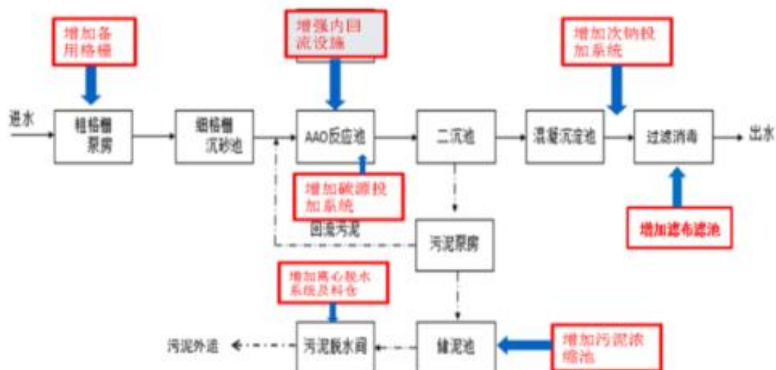
图 4-2 提标后科福污水处理厂工艺流程
